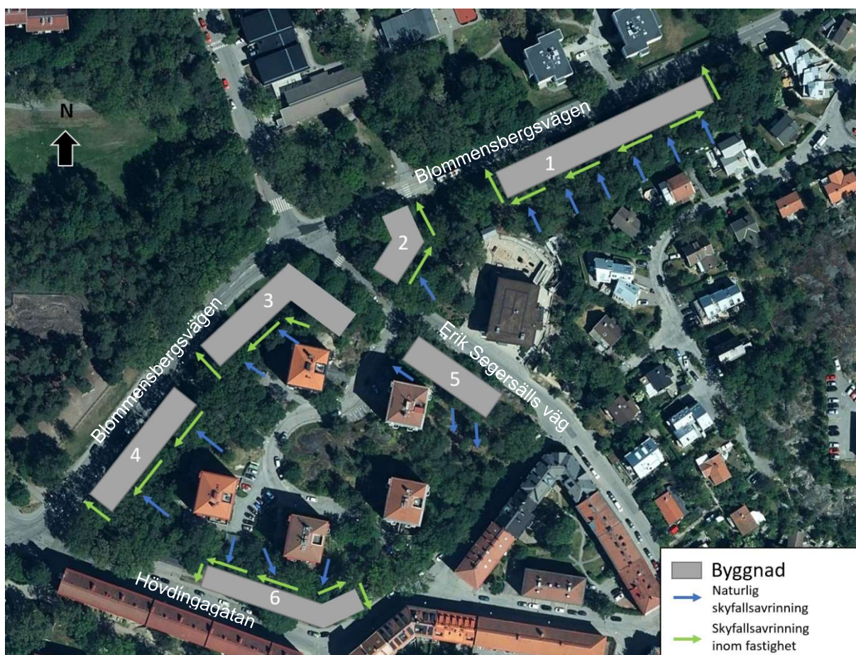
Figur 7-3. Rinnvägar vid extrema regnhändelser. Höjdsättning och olika typer av diken gör så att vatten kan rinna runt huskropparna Bild från (Eniro, 2023).
