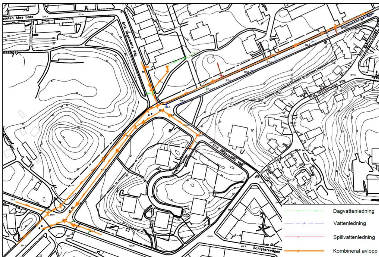
Figur 3-1. Befintligt ledningsnät inom planområdet med pilar som visar det kombinerade avloppets flödesriktning.
