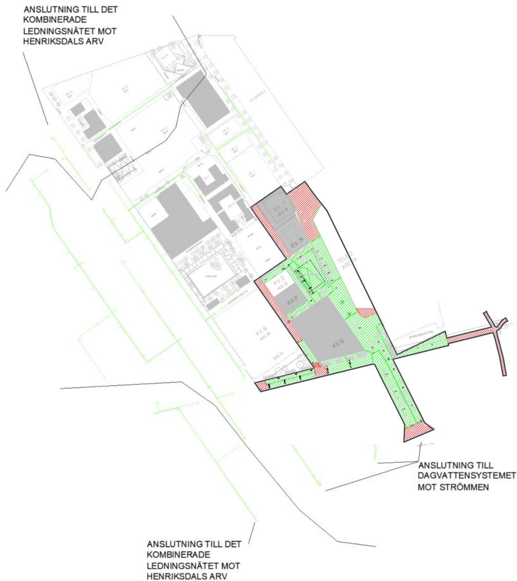
Figur 12. Ledningsnätets framtida utformning i Slakthusområdet. Från aktuell detaljplan (Evenemangskvarteret, 4a) ansluts ledningsnätet till dagvattensystemet mot Strömmen
