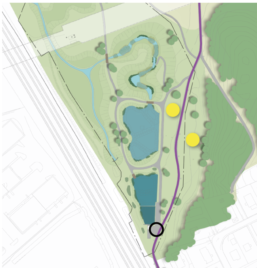
Illustration över befintligt gång- och cykelstråk (lila linje) samt uppställningsplats och vändyta för driftsfordon (svart cirkel). Gula markeringar är föreslagna alternativ för placering av geotuber vid muddring av dammarna.
