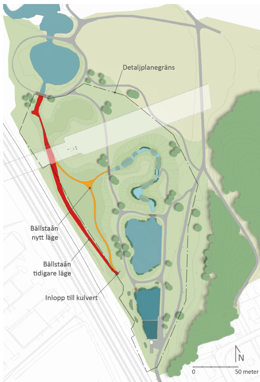
Illustrationsplan med Bällstaåns befintliga sträckning markerat med rött och dess föreslagna sträckning markerat med orange. Detaljplanegräns är markerad med grå streckad linje. (Ramboll, 2021).
