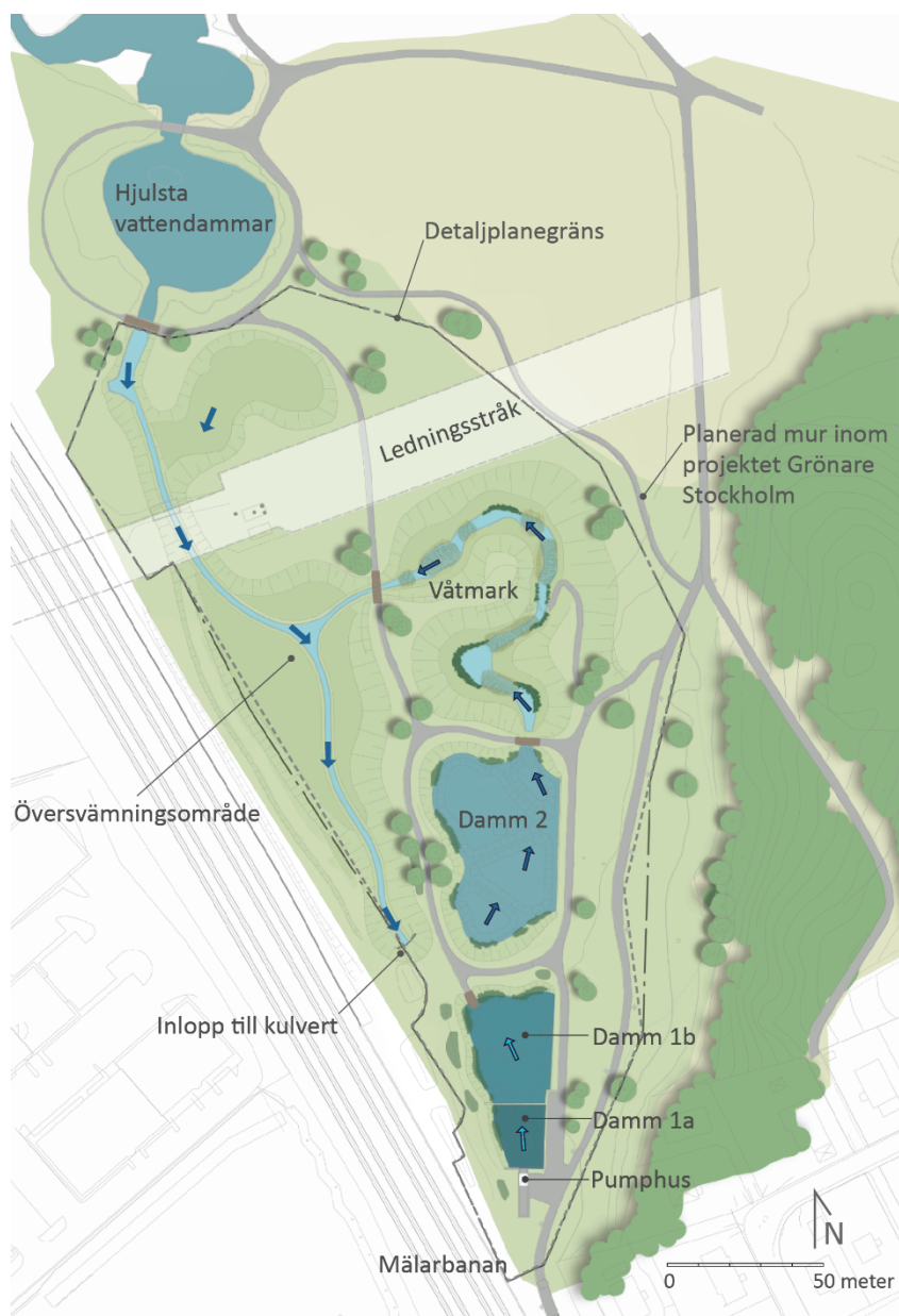
Möjlig utformning av dammar och översvämningsyta. Pilarna visar vattnets flödesriktning (Ramboll, 2021).
