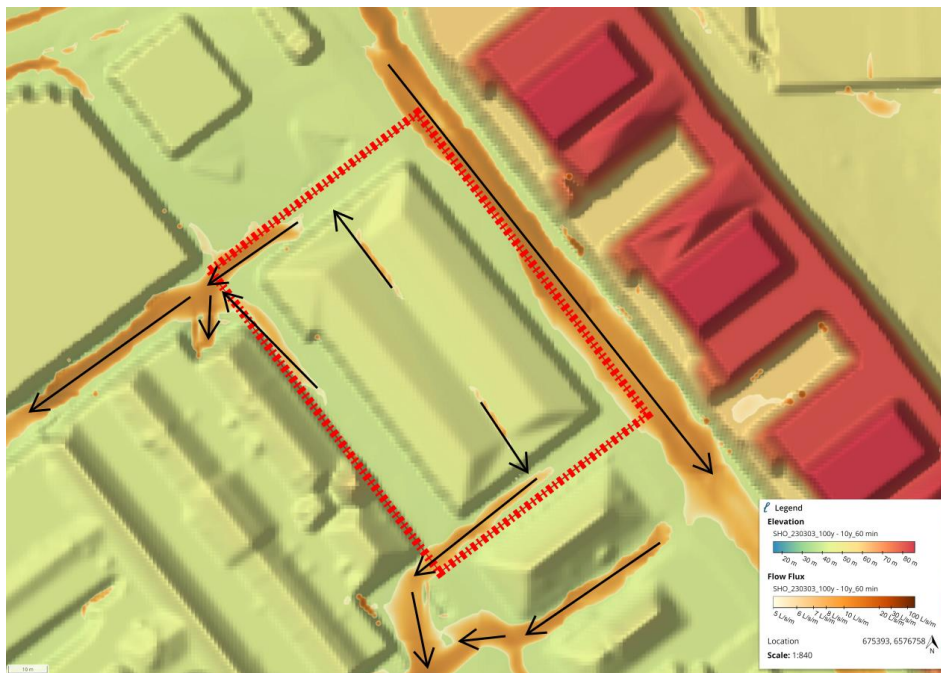
Figur 15 Flödesvägar inom Dp 2d. Tjocka, svarta pilar visar på flödesriktning. Nyanser av orange indikerar olika storlekar på flödet, större flöden vid mörk nyans.
