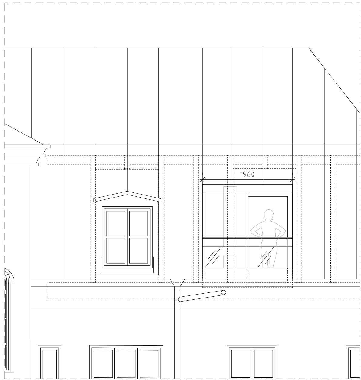
FASAD MOT GÅRD. BEFINTLIG TAKKUPA MED SÅNKT BRÖSNING. NY TAKTERRASS ERSÄTTER TAKKUPA.
