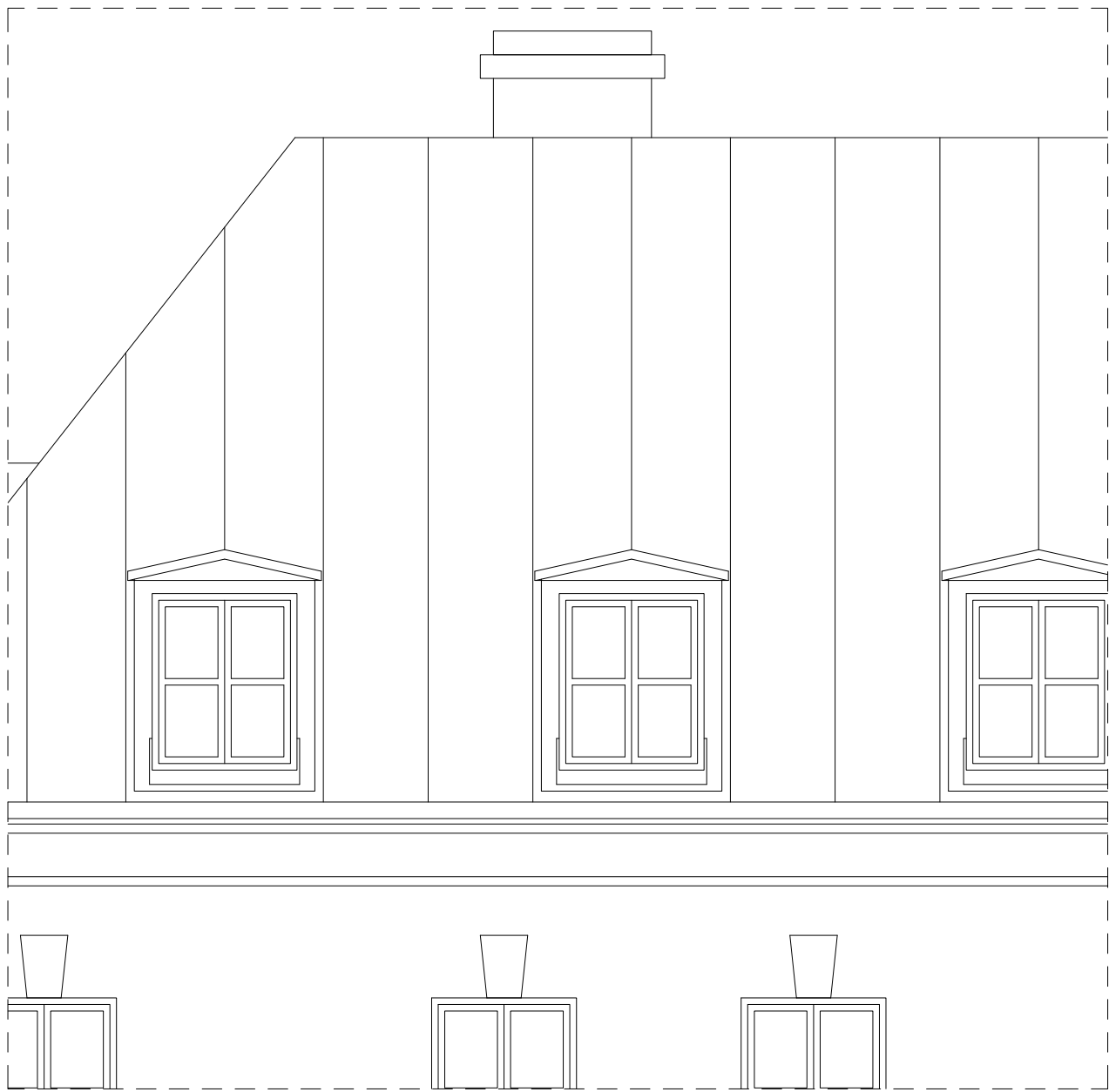
FASAD MOT GATA. BEFINTLIGA TAKKUPOR MED SÅNKT BRÖSTNING.
