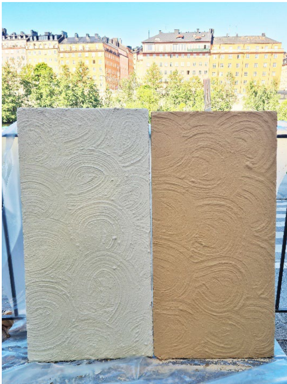
Uppstrykningsprover med de båda föreslagna kulärena. Dessa kom senare att användas vid avfärgningen av den nya fasadputsen.
