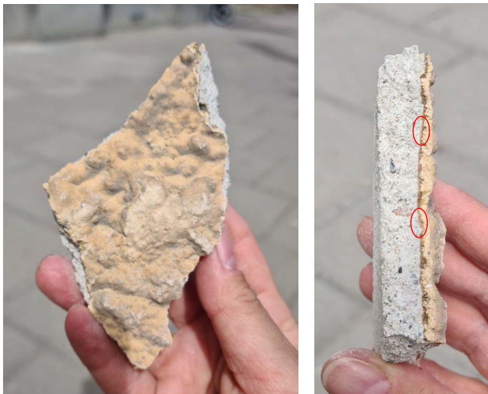
Till vänster: Putsbit från en av ytorna mellan kolossalpilastrarna. Till höger: Samma putsbit, sedd från sidan. Under den senaste tillkomna aprikosgula, tjockt pålagda avfärgningen återfanns en chokladbrun kulör och därunder en tunt struken varmgul ton, vars kulör överensstämde med tidigare upprättat färgsättnings-pm. De röda cirkelade ringar in ställen där den ursprungliga varmgula avfärgningen bäst kan anas.
