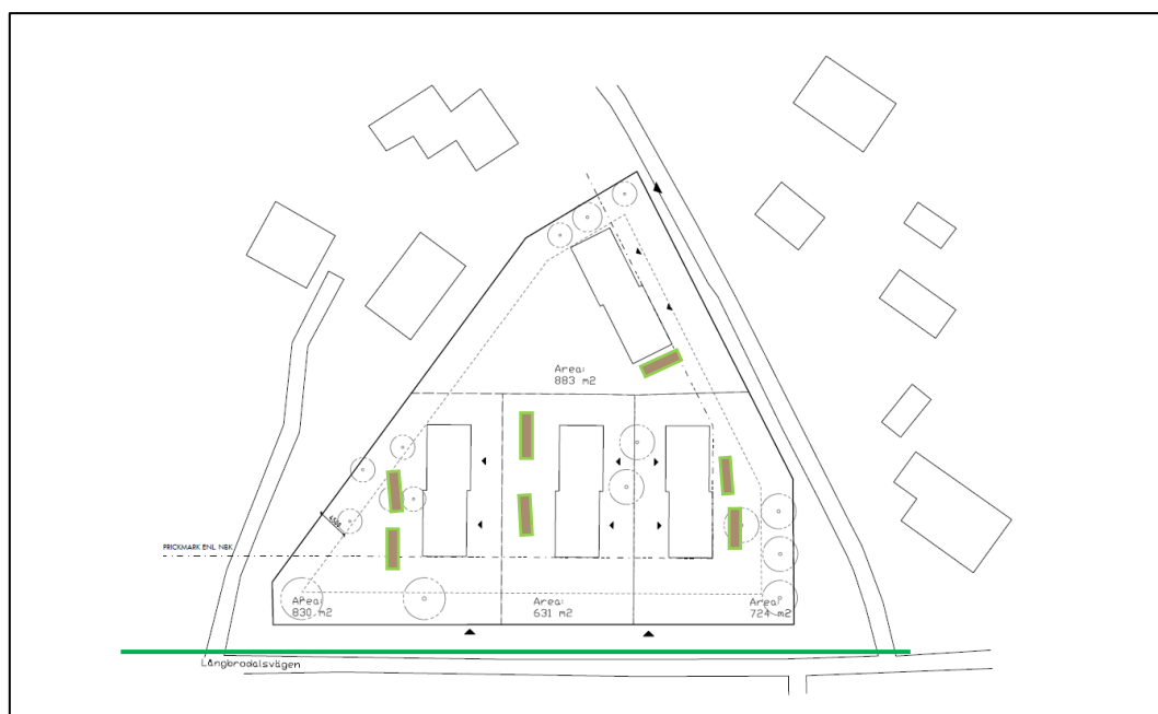
Figur 3: Skiss på dagvattenhantering inom planområdet. Gröna polygoner visar ungefärlig föreslagen placering av biofilter/växtbäddar. Grön linje motsvarar ungefärligt läge för befintlig dagvattenledning.
