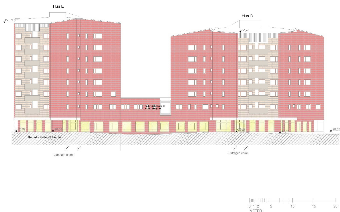
Fasad mot öster, Tengbomgruppen, 2023-06-09, gulmarkerat nya partier i befintliga utökade fönsteröppningar.
