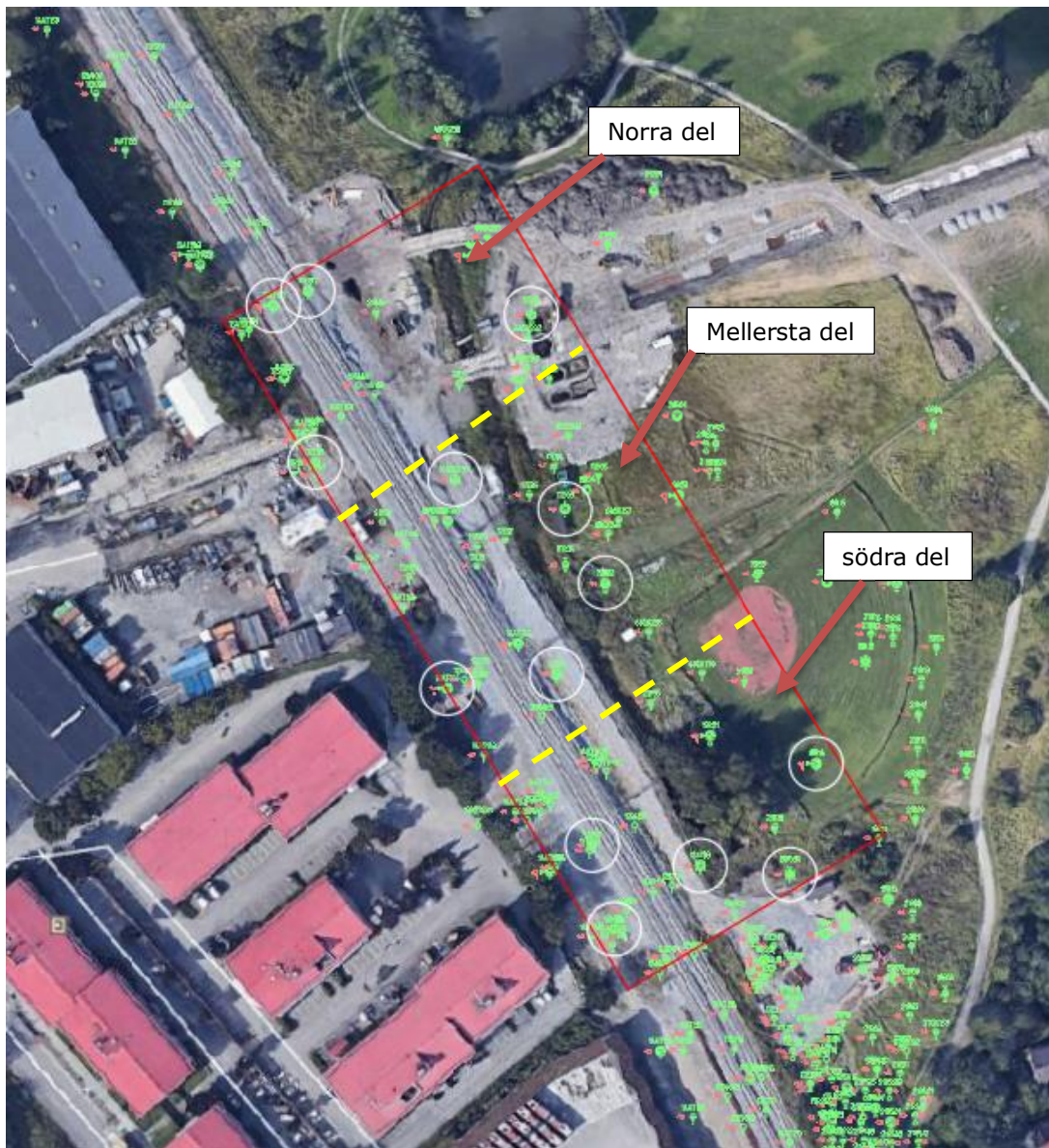
Figur 9 Intresseområdet och undersökningarna kolv/vinge tillämpade för utvärdering av skjuvhållfasthet. Röda linjen omringar intresseområdet för sonderingar. De framhävda undersökningarna inom röda begränsade området har använts för utvärdering av skjuvhållfasthet. Sonderingarna har uppdelats i tre områden för att redovisa den gemensamt valda skjuvhållfasthet profilen närmare med mindre områden. (foto: Google Maps)
