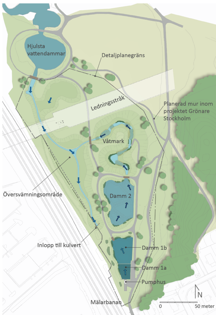
Föreslagen utformning av dammar och översvämningssyta. Pilarna visar vattnets flödesriktning (Ramboll, 2023).
