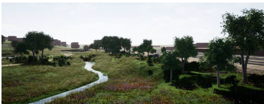
Perspektiv som visar möjlig utformning sett från nordväst. Åfåran föreslås flyttats för att öka avståndet till Mälarbanan samt för att skapa fördröjningsmöjlighet med flacka slänter. Illustration: Ramböll.
