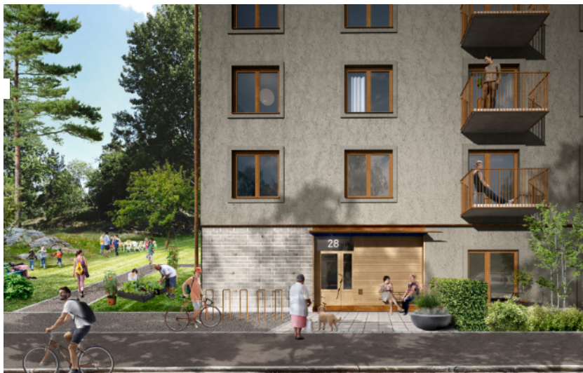
Principbild för Stockholmshuset. Sockelvåningen utförs i puts i samma kulör som fasad. Entréparti utförs i ask eller ek samt med glas. Entrépartiet utförs något indraget och med skärmtak. Det kompletteras med identitetsbärande detaljer för Stockholmshuset såsom sittbänk, draghandtag och adresssiffra. Bild Dinell Johansson.
