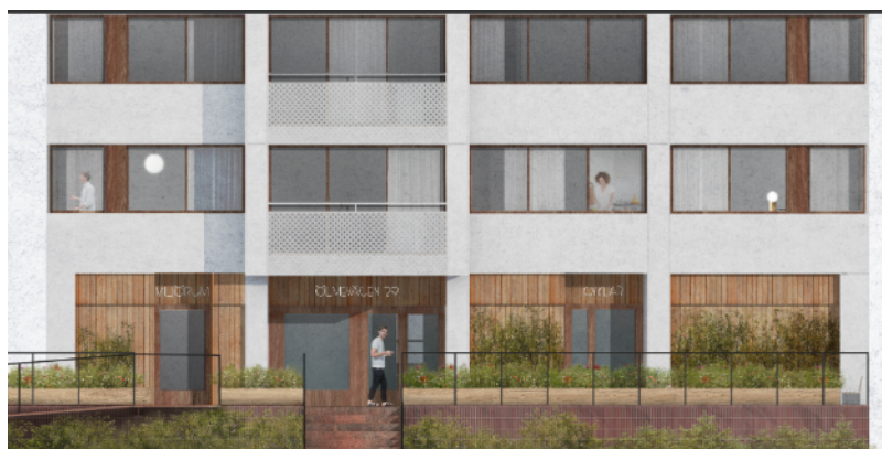
Sockelvåningens utförande i huvudsak av trä. Fönsterband som är indragna från fasad och gestaltade i avvikande kulör. Elementskarvar ska utföras som en del av gestaltningen. Suterrängvåningens gestaltning. HOW Arkitekter
