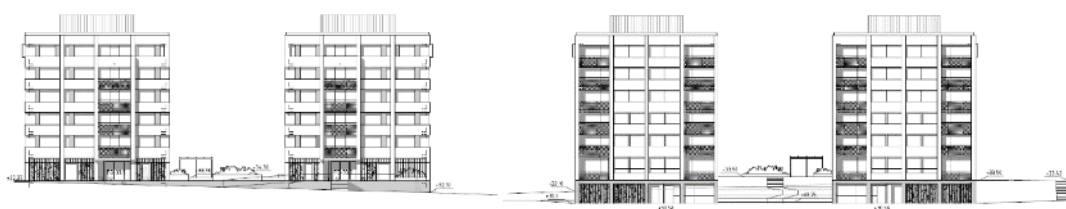
Fasadens gestaltning med fönsterband som är indragna från fasad och gestaltade i avvikande kulör. Balkonger som är integrerad i volym. Elementskarvar som utförs som en del av gestaltningen. Bild till vänster från Ölmevägen och till höger från gård. HOW Arkitekter
