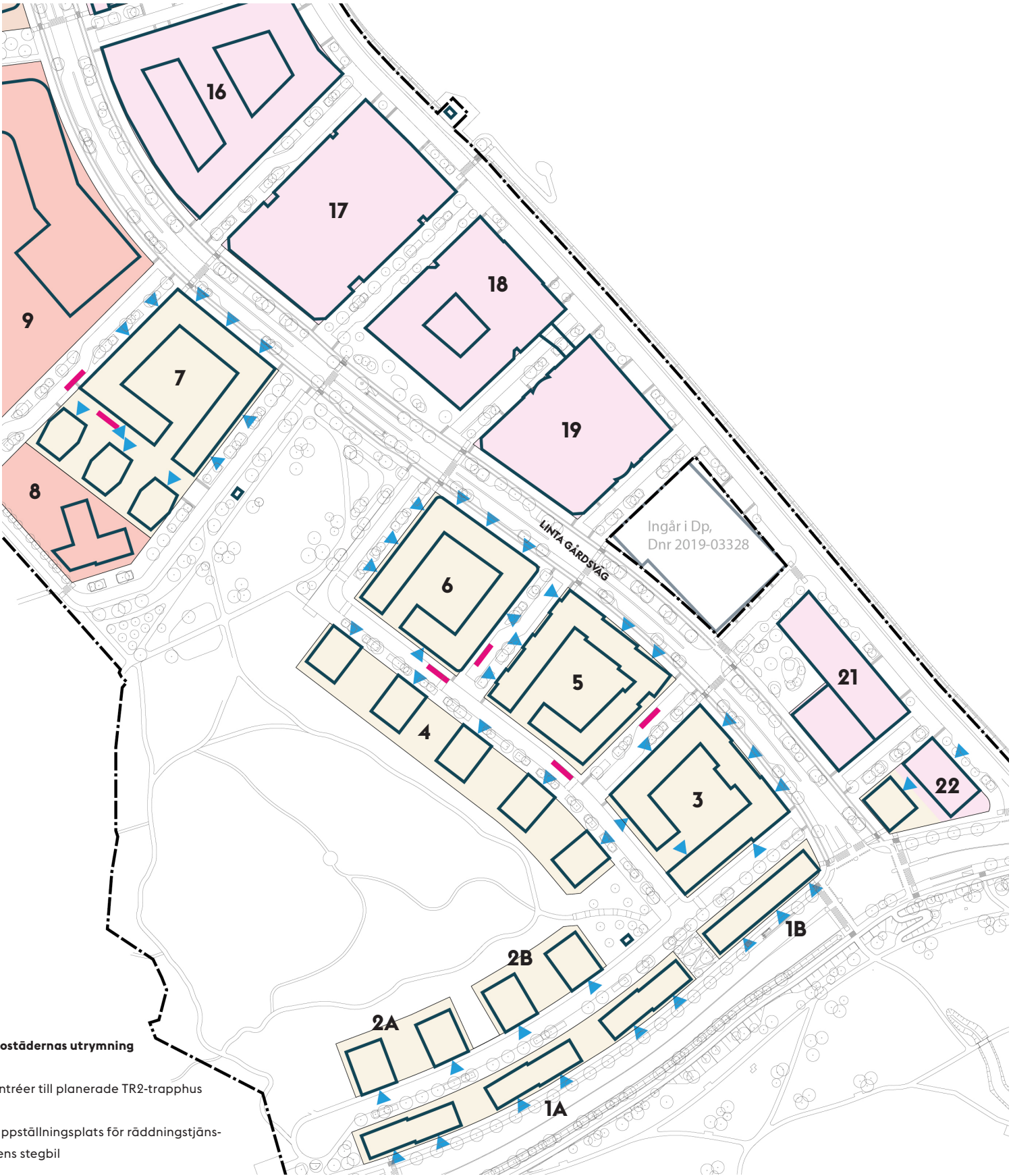
Bild 1: Planillustration över bostädernas utrymning med planerade lägen för TR2-trapphus respektive uppställningsplats för räddningstjänstens stegbil. Numrerade kvarter ingår i efterföljande kvartersvisa redovisning.
