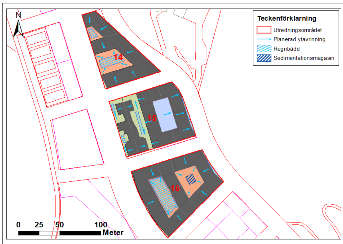
Figur 9-8. Förslag på dagvattenhantering för Kvarteren 14, 15 och 16 (Geosigma, 2022-09-07).
