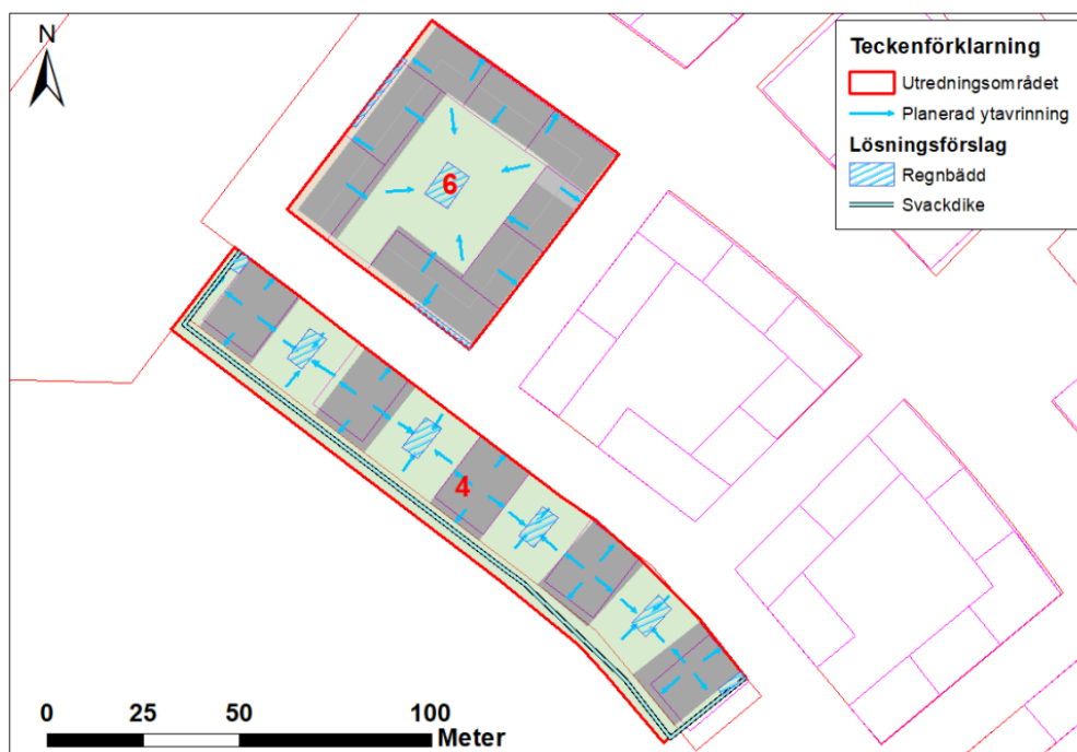
Figur 9-6. Förslag på dagvattenhantering för Kvarter 4 och 6 (Geosigma, 2022-09-07).
