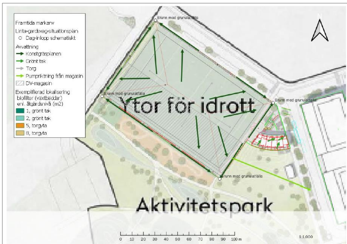
Figur 9-12. Avvattningsplan för Kvarter 12 (Sweco, 2022-08-17).
