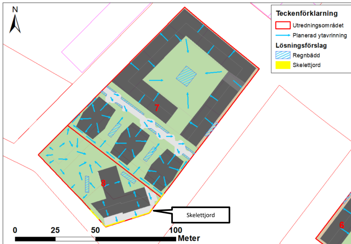
Figur 9-7. Förslag på dagvattenhantering för Kvarteren 7 och 8 (Geosigma, 2022-09-07).
