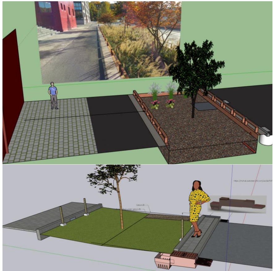
Figur 16. Nedsänkta planteringar som det skulle kunna se ut längs Huvudgatan, brunn DB1. Nedre bild visar den i projektet utvecklade brunnen med linjeavvattningsränna som för vattnet från gata till växtbädd utan att förlora mer än 5-10 cm i höjd. Nollad kantsten från GC ytor eller släpp i kantstenen.
