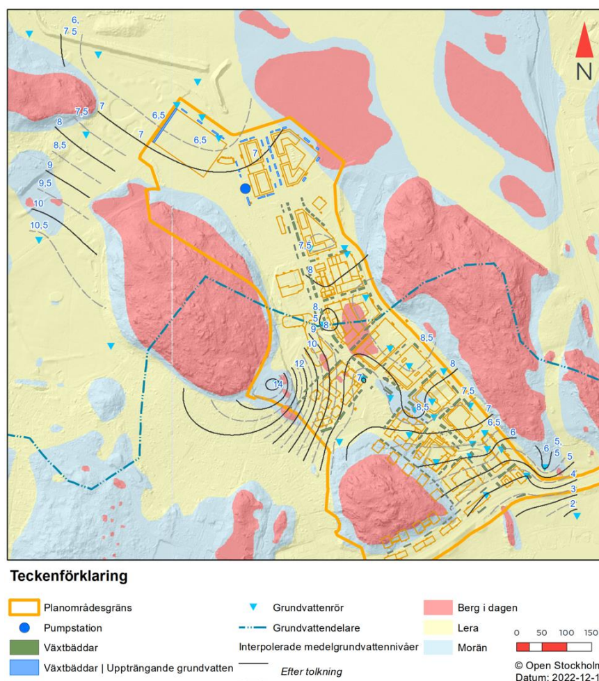
Figur 10. Schematisk bild av planerade kvarter och mellanliggande gator med växtbäddar. Blåmarkerade växtbäddar i de norra delarna riskerar under delar av året (vinter-vår) erhålla uppträngande grundvatten om de inte utförs täta eller utan dräneringsledningar (Källa: WSP, 2023a).
