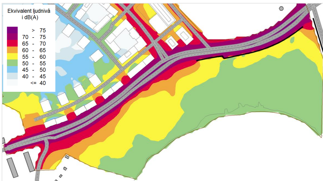
Figur 9. Ekvivalent ljudnivå från vägtrafik över Lillsjöparken, prognosår 2040. Beräkning inkluderar en 2 m hög bullerskyddsskärm längs Kvarnbacksvägen och en 2,5 m hög skärm längs Ulvsundavägen. Lillsjön är markerad med grå linje och bullerskyddsskärmar med svarta linjer. Plangräns är markerad i brunt.
