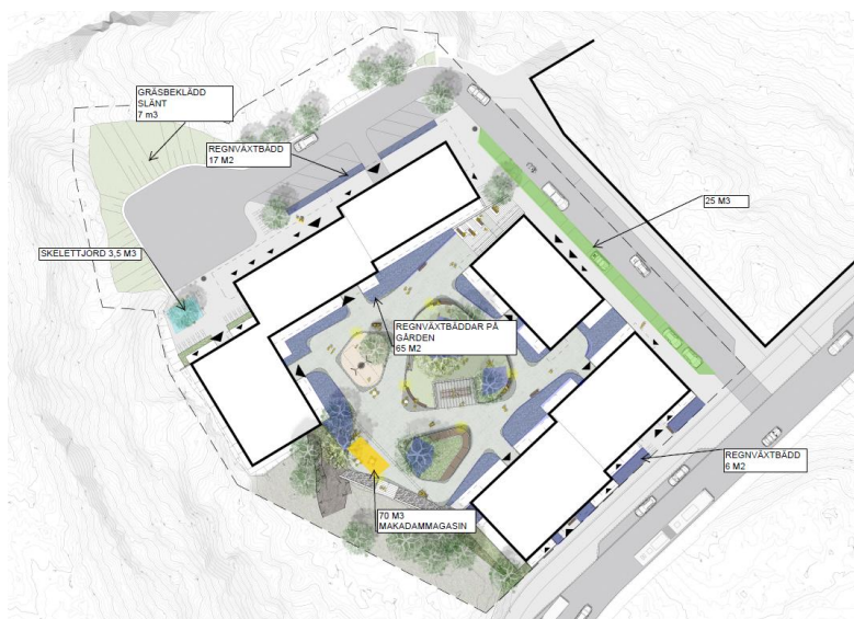
Figur 11. Illustrationsplan med magasin placering samt fördröjningsvolym
