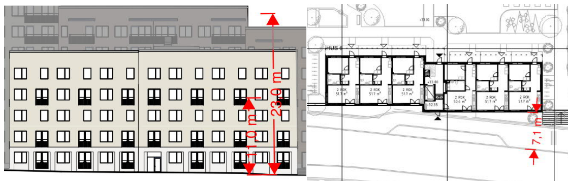
Figur 3. Plan 11-12 samt 13-14 utgörs av etagelägenheter. Alternativ utrymningsväg sker via balkong med hjälp av räddningstjänstens stegutrustning. I vänstra bilden har höjd 11 meter respektive 23 meter markerats vid fasad för att visa var steg kan användas samt att stegbil kan användas. I högra bilden ses avstånd mellan byggnad och gata som kan användas för uppställning av stegbil.
