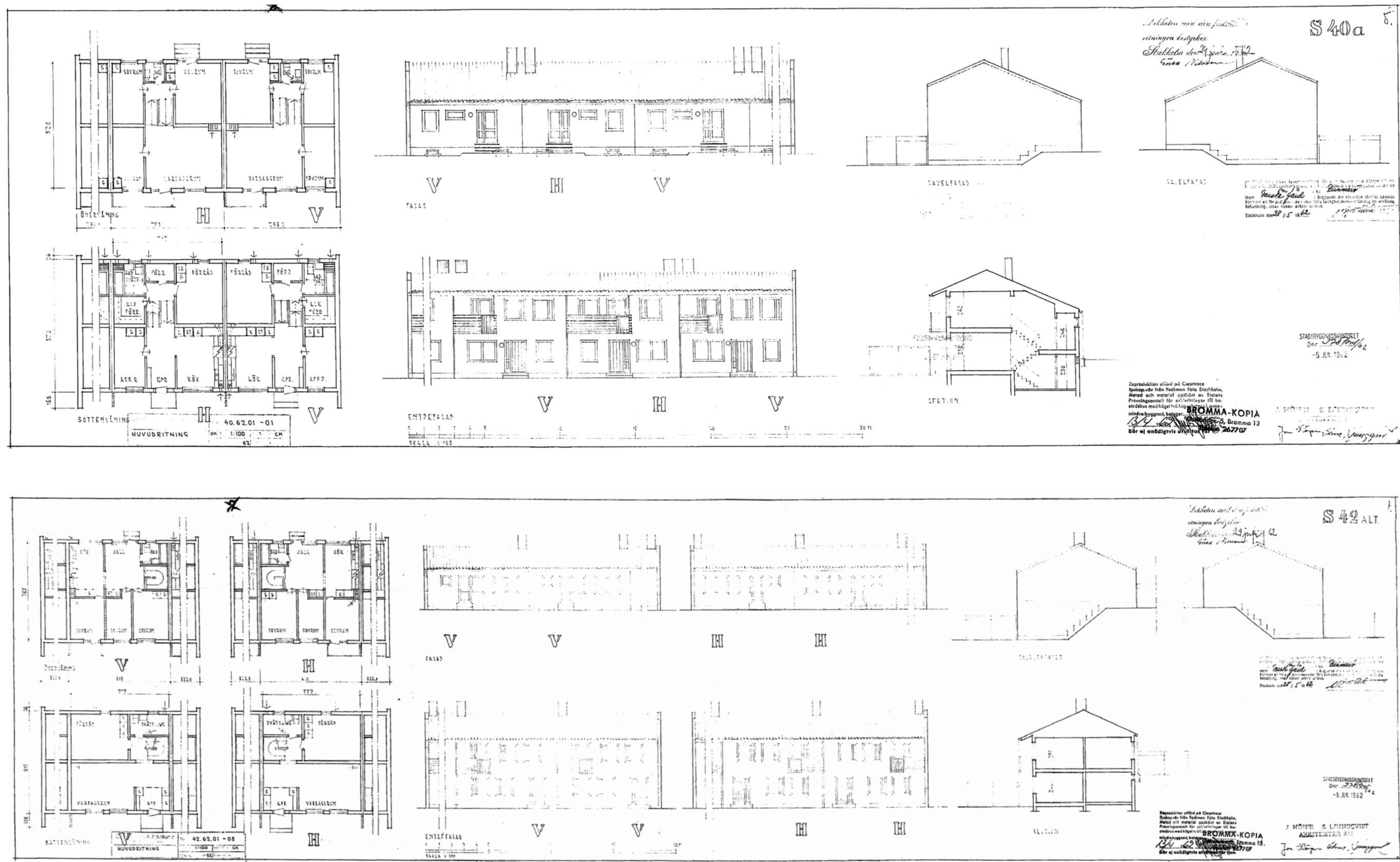
Plan- och fasadritningar för radhustyperna S 40 a och S 42 som uppfördes inom Kv. Runmarö. Ritningarna är daterade 1962 och signerade av J. Höjer och S. Ljungqvist Arkitekter. Källa: Stockholms stadsbyggnadsnämnds arkiv
