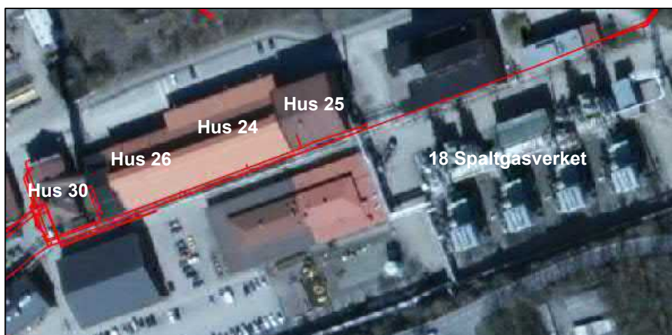
Figur 3. Lokalisering av tjärledning. Tjärledningen öster om hus 25 har rivits och marken kring ledningen är sanerad.
