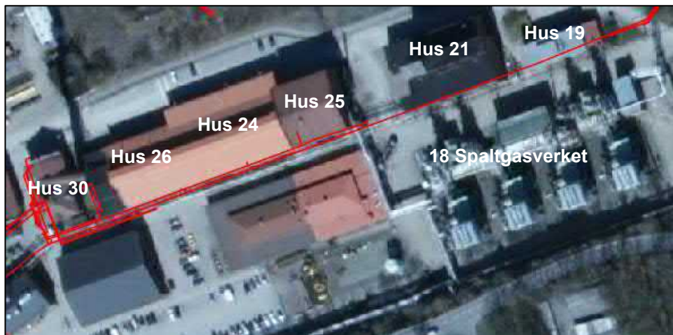
Figur 2. Lokalisering av tjärledning. Tjärledningen öster om hus 25 har rivits och marken kring ledningen är sanerad.
