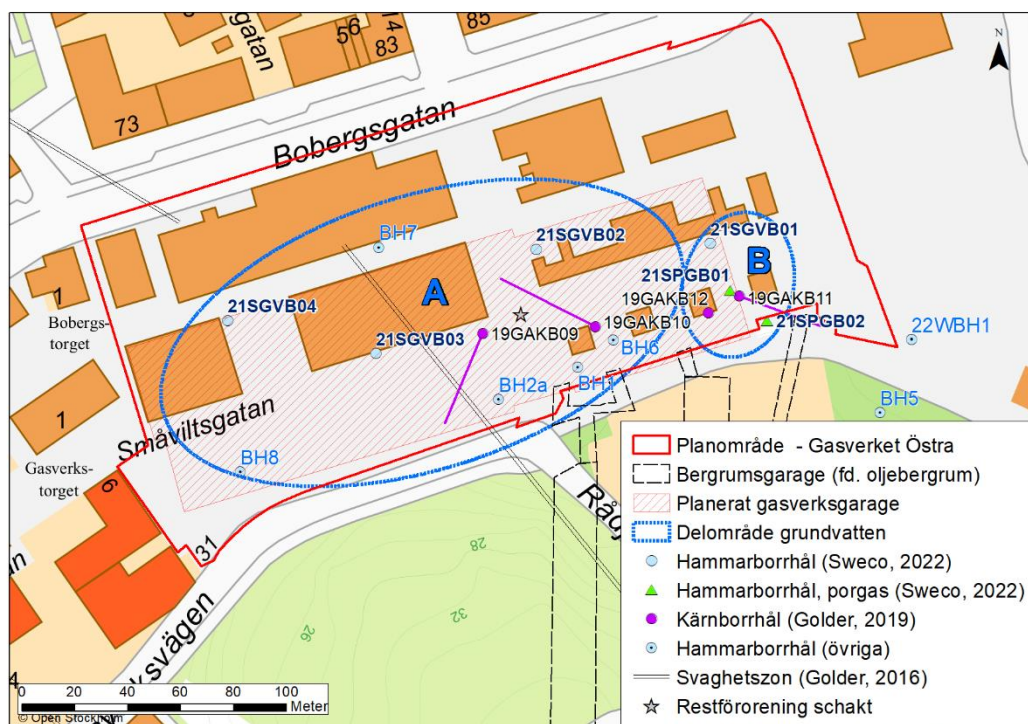
Figur 21. Översikt av bergborrhål i anslutning till detaljplaneområdet, identifierade delområden beroende på sammansättning av föroreningar samt utbredning av bergschakt för garage, utdrag ur Bilaga B. Grå stjärna markerar ungefärligt läge för den petroleumförorening (PAH och aromater) som påträffades i samband med bergschakt för Terminalgatan under 2015. © Open Stockholm.
