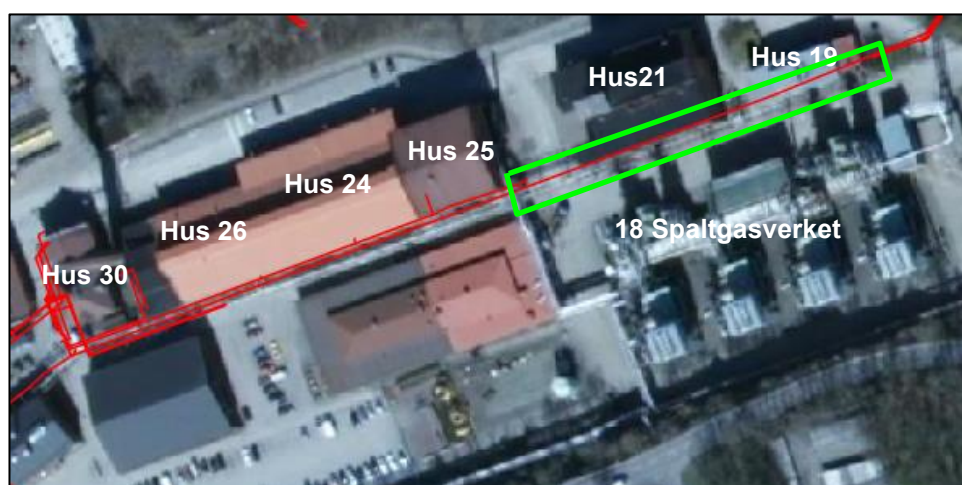
Figur 15. Lokalisering av tjärledning. Tjärledningen öster om hus 25 har rivits och marken kring ledningen är sanerad, se grön markering.
