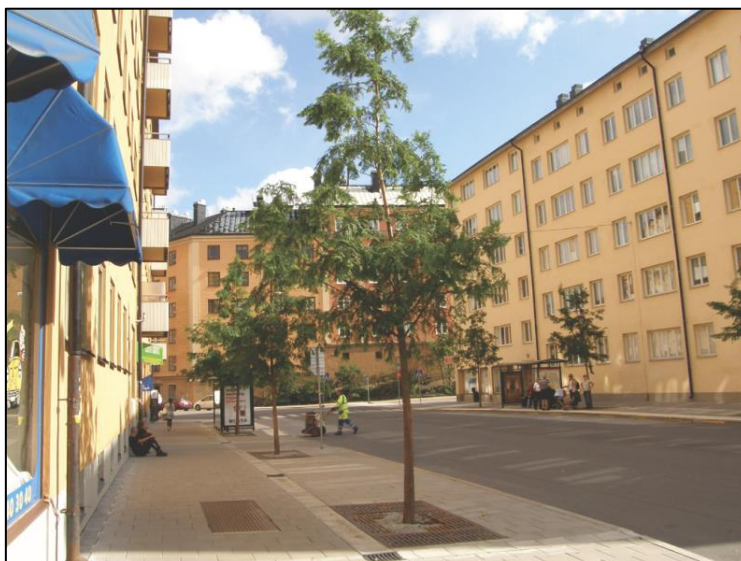
Figur 8:2. Exempel på trädrad i skelettjord. Dagvatten avleds till skelettjord via dagvattenbrunnar/luftningsbrunnar
