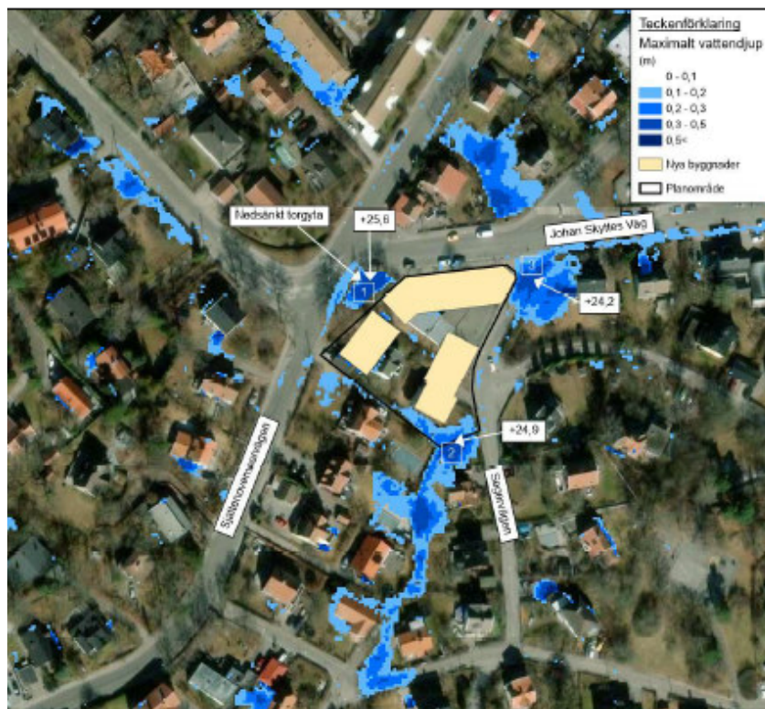
Resultat med maximala vattendjup från simulering vid ett 100-årsregn med 30 minuters varaktighet och klimatkfaktor 1,25. Lågpunkterna har numrerats 1-3.. Bild Norconsult, PM Skyfall 2023-03-03.
