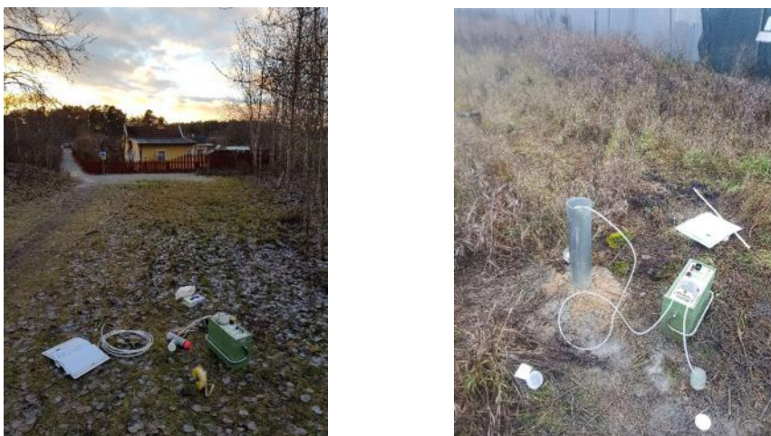
Figur 5: Rens- och omsättningspumpning i grundvattenrör 18GA04 samt 18GA03.
