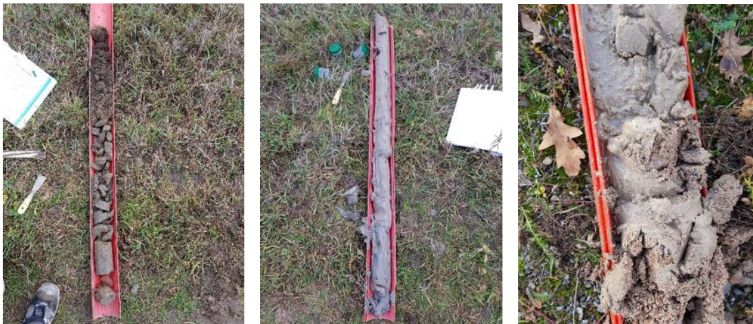
Figur 4: T.v torrskorpelera i provpunkt 18GA20, i mitten fuktig grålera i provpunkt 18GA20, t.v friktionsjord i provpunkt 18GA04. Provtagning med rotasonic.
