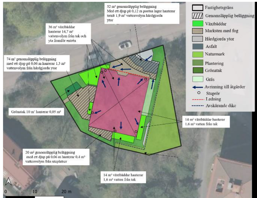
Föreslagen dagvattenhantering inom den östra fastigheten. Bild: WRS.
