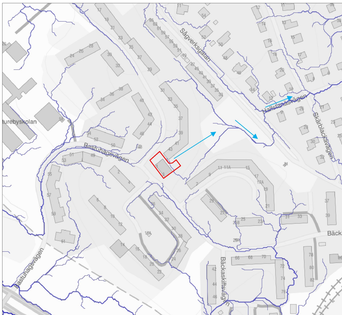
Figur 8. Befintliga flödesvägar (blå pilar visar vattnets flödesriktning). Bild: Scalgo Live.
