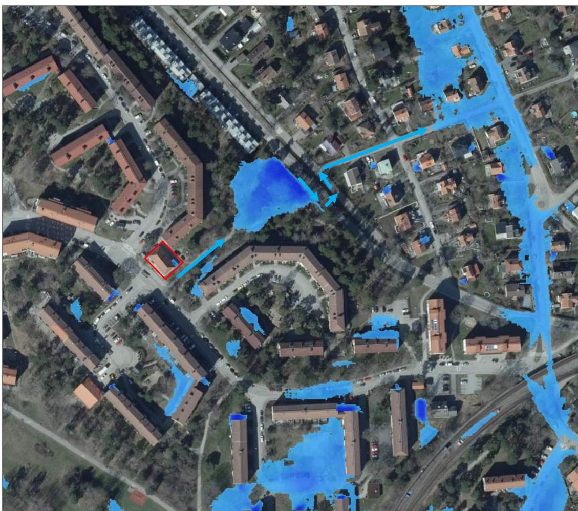
Figur 9. Lågpunkter där vatten ställer sig vid ett 100-årsregn, samt flödesvägar. Modelleringen tar inte hänsyn till infiltration (Scalco Live).
