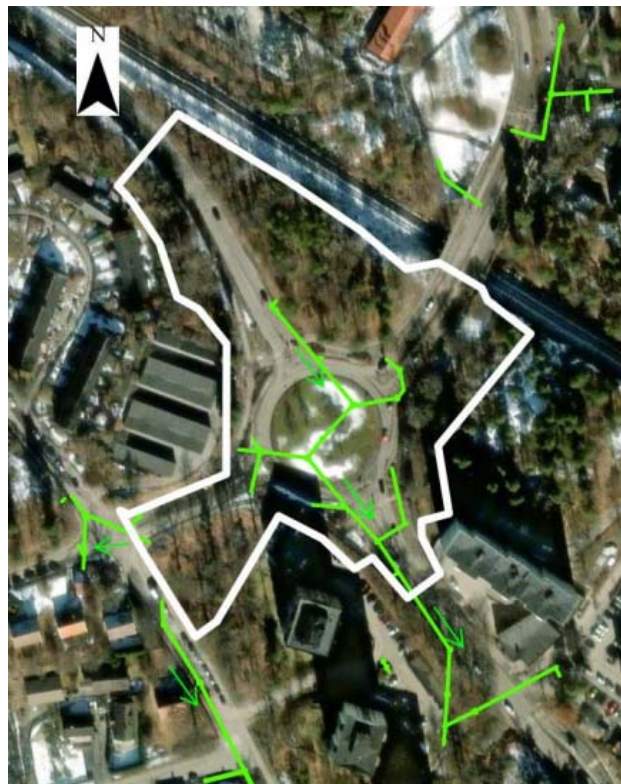
Befintligt dagvattenledningsnät (gröna linjer) inom planområdet (markerat med vit). Flödesriktningen i ledningsnätet anges med parallella gröna pilar. (SWECO 2023)
