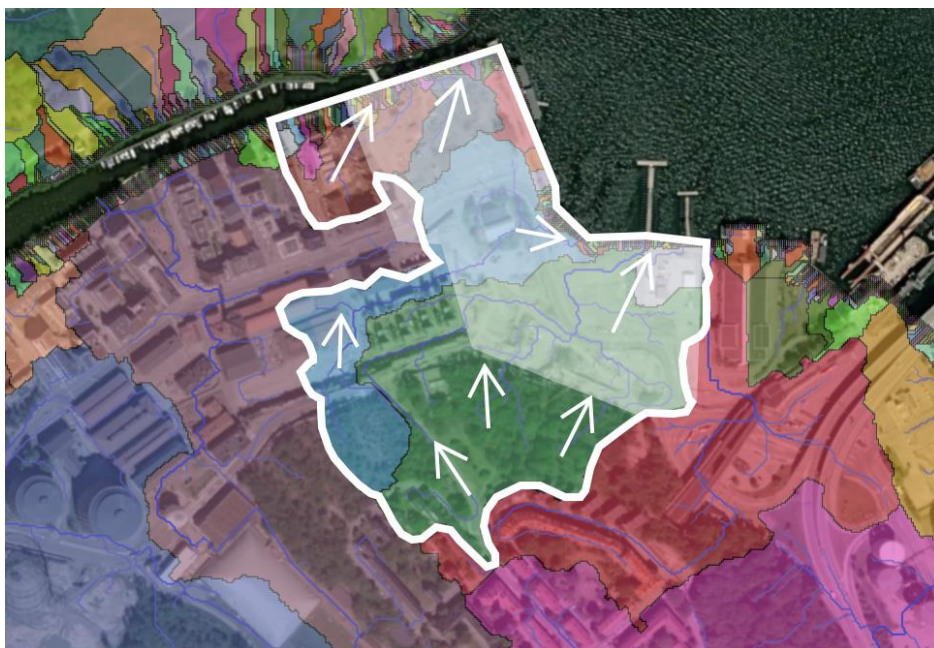
Figur 9. Ytligt delavrinningsområde uppströms Kolkajens planområde markerat med vit ytterlinje, planområdet med vit skuggning och generella flödesriktningar som vita pilar. De flerfärgade fälten är ytliga delavrinningsområden, baserat på urklipp ur Scalgo Live 2021.
