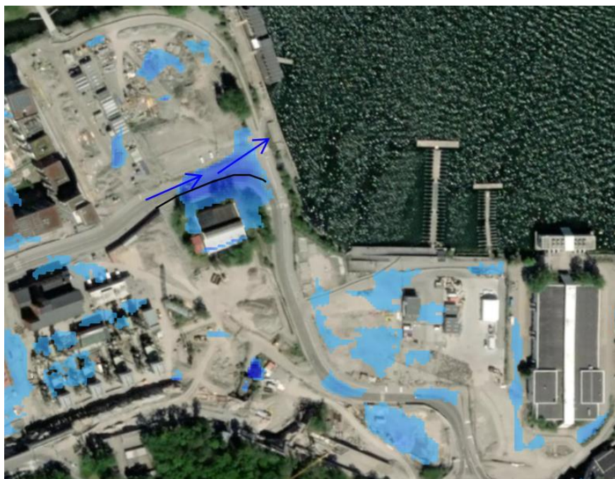
Figur 13. Lågpunktskartering från Scalgo Live. En större instängd lågpunkt är belägen vid Vattengasverket men avrinningsområdet dit är begränsat tack vare skyddande kantstenar längsmed Bobergsgatan (markerad svart linje).
