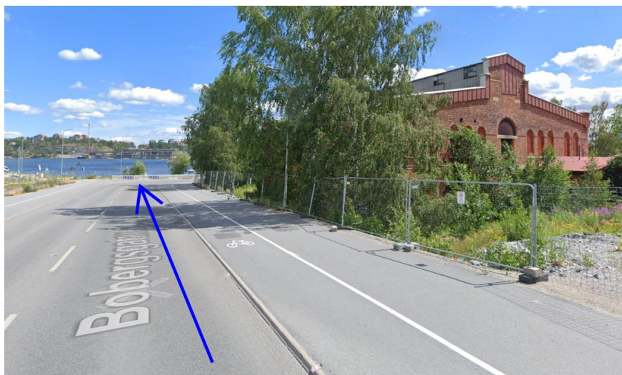
Figur 14. Kantsten längsmed Bobergsgatan skyddar Vattengasverkstomten från ytligt inkommande flöden (bild från Googles karttjänst).
