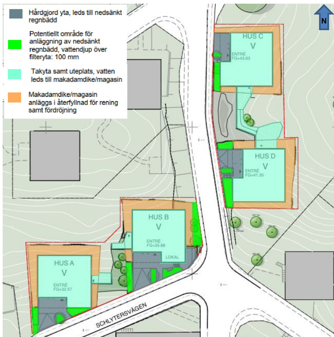
Figur 11. Övergripande koncept på dagvattenhantering inom utredningsområdet där ytor redovisas med möjlighet att anläggas som växtbäddar.
