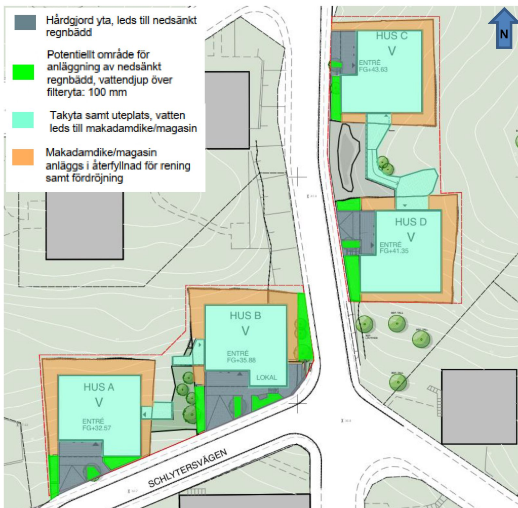
Figur 7. Avrinningsområden för växtbäddar för rening av dagvatten från hårdgjorda markytor för att gå i linje med Stockholm stads åtgärdsnivå. Nedsänkta regnbäddar utformas med 100 mm vattendjup över filteryta och dräneringshastighet på 100 mm/h.
