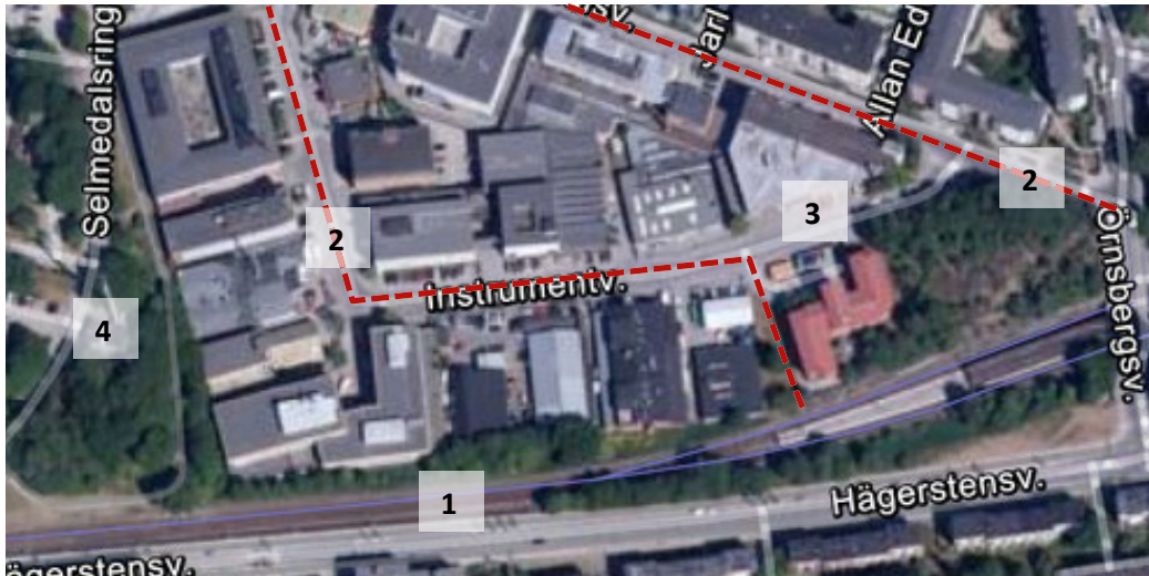
Figur 2. Identifierade riskkällor i närområdet. 1 – tunnelbana, 2 – markförlagd gasledning (röd streckad linje), 3 – restaurang som använder gasol, 4 – spetsanläggning för fjärrvärme.
