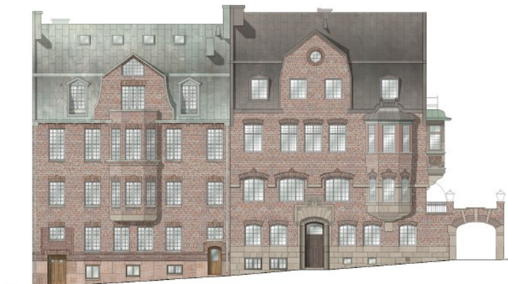
Gatufasader för Sköldungagatan 6 och 4. Befintliga fasader till vänster och fasader med rekonstruerade fönster enligt planförslag till höger.
