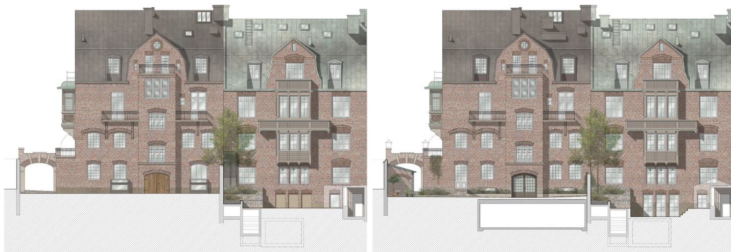
Gårdsfasader för Sköldungagatan 4 och 6. Befintliga fasader till vänster och fasader med rekonstruerade fönster och ändring i bottenvåning samt tak enligt planförslag till höger.
