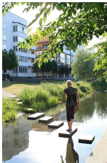
Figur 10. Integrera välfungerande och hållbara system för dagvatten. Utnyttja mark, växtlighet och vattensamlingar för att rena vatten och jämna ut flöden.
