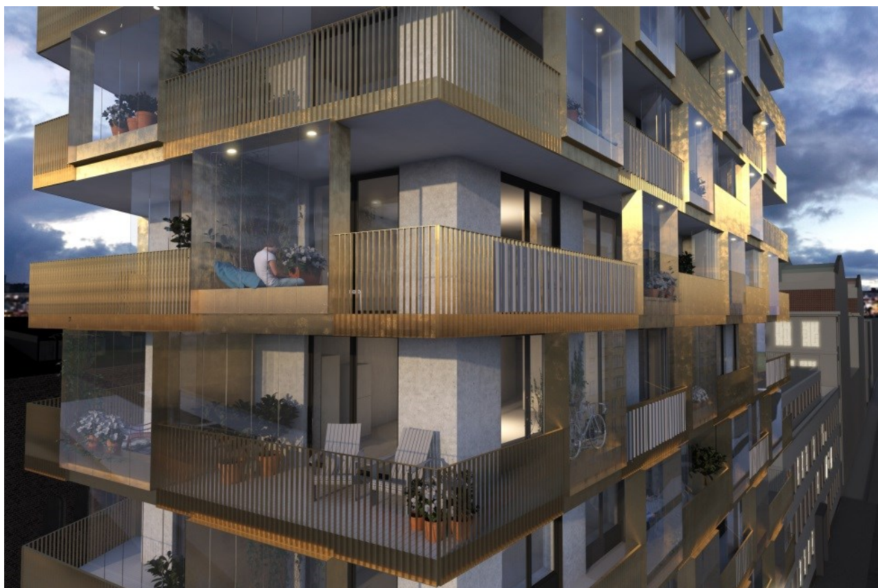
Längsgående balkonger med pinnrör i metall, öppna ytor runt hörn och inglasade ytor med glasboxar och vikbart inglasningssystem
